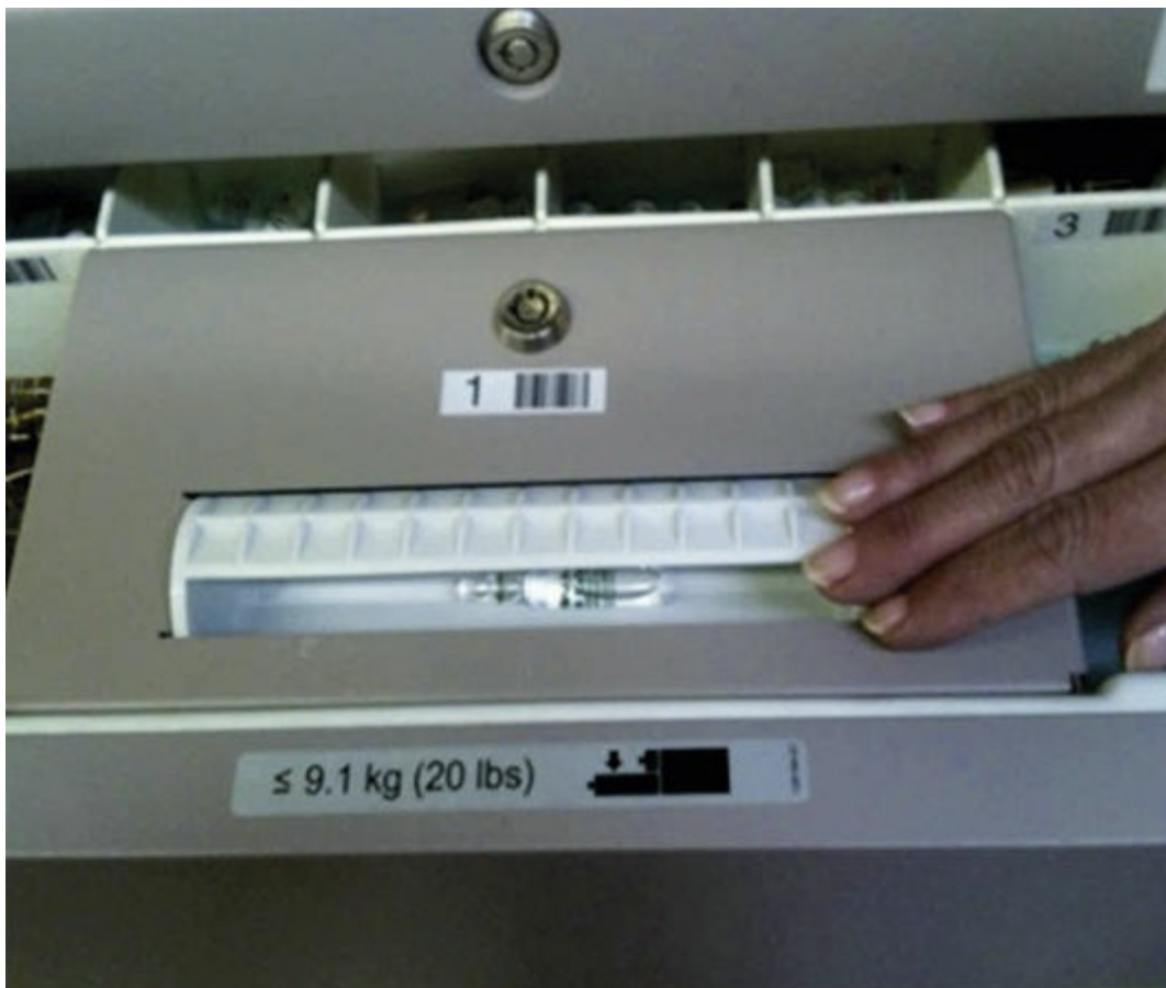
FIGURA 6.12 Gaveta de devoluciones de estupefacientes. Modelo Medstation® RX system, de Pyxis (distribuido por Grifols Internacional).
