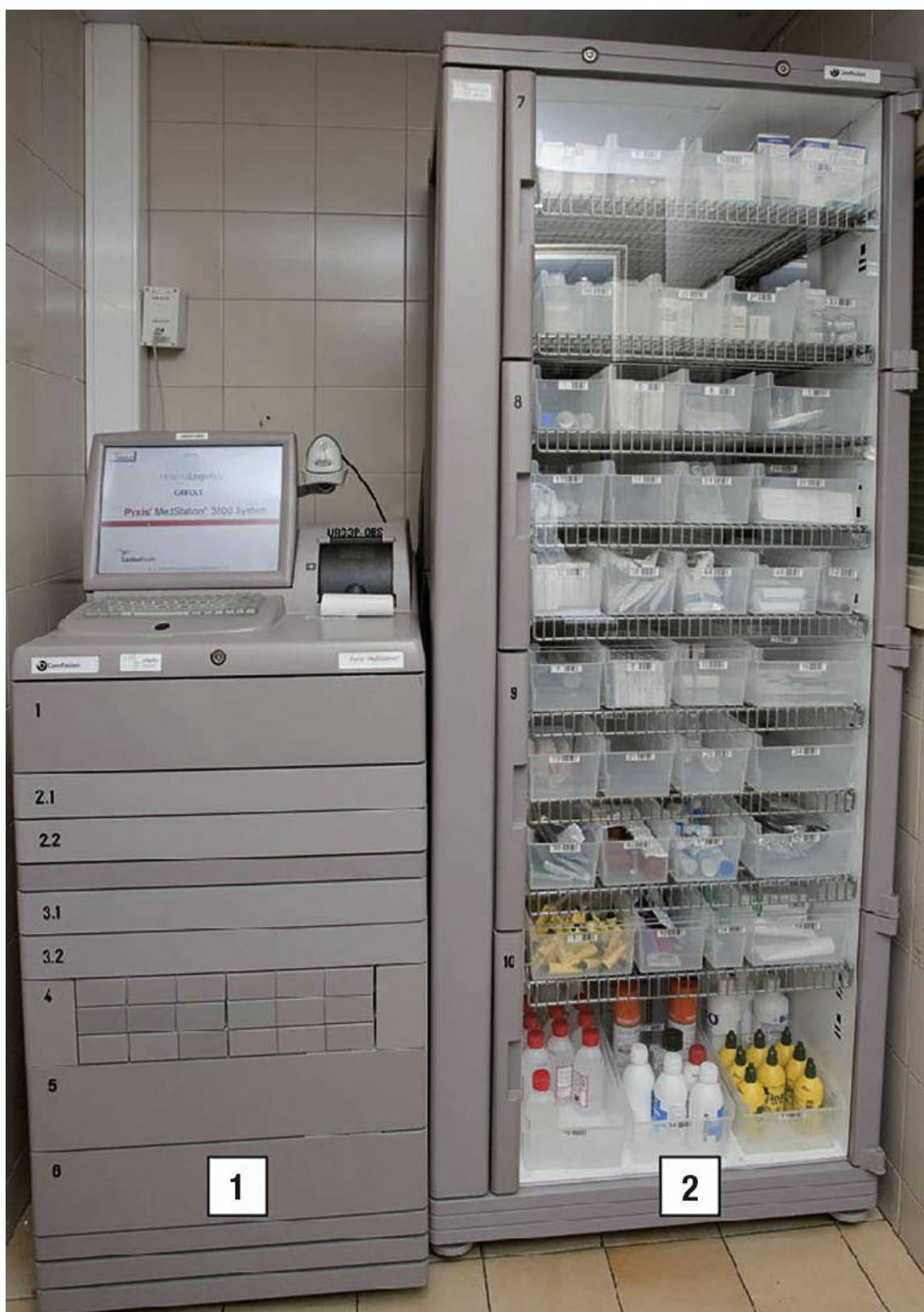
FIGURA 6.2 Modelo Medstation® RX system, de Pyxis (distribuido por Grifols Internacional). 1. Módulo main o principal. 2. Módulo auxiliar.
