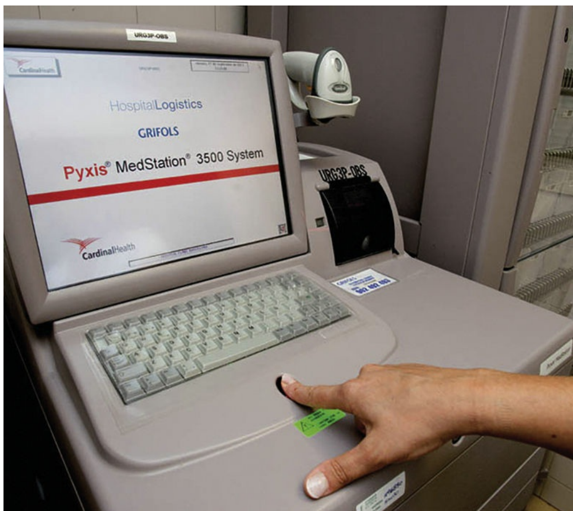
FIGURA 6.6 Reconocimiento de la huella digital para el acceso al sistema. Medstation® RX system, de Pyxis (distribuido por Grifols Internacional).
